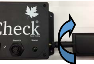
Figure 1a. Vissez l'antenne dans le port d'antenne sur le côté du contrôleur SapCheck.
