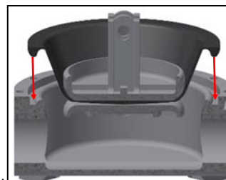
La lèvre extérieure du diaphragme s'insère dans la rainure du corps de la pompe
