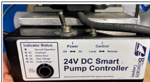
Boîtier de commande de la pompe affichant des interrupteurs d'activation manuelle et à distance sur le dessus du boîtier et un indicateur d'état des défaillances sur le côté.
