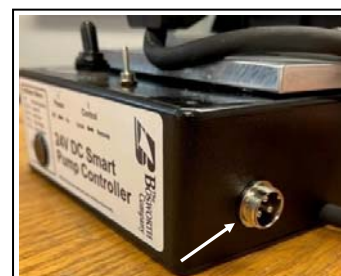
Interface de télécommande sur le côté du boîtier de commande
