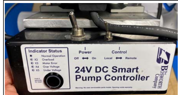
Boîtier de commande de la pompe affichant des interrupteurs d'activation manuelle et à distance sur le dessus du boîtier et un indicateur d'état des défaillances sur le côté.
