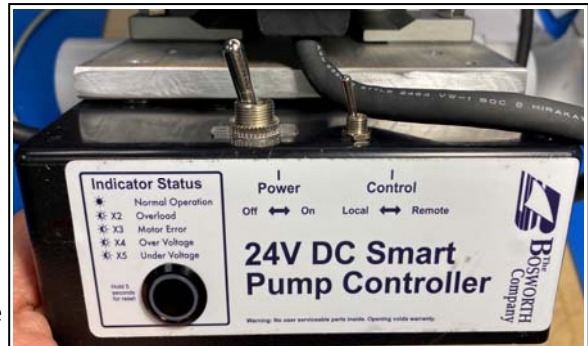
Boîtier de commande de la pompe affichant des interrupteurs d'activation manuelle et à distance sur le dessus du boîtier et un indicateur d'état des défaillances sur le côté.
