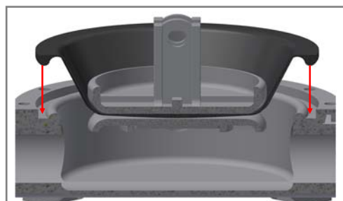
La lèvre extérieure du diaphragme s'insère dans la rainure du corps de la pompe.
